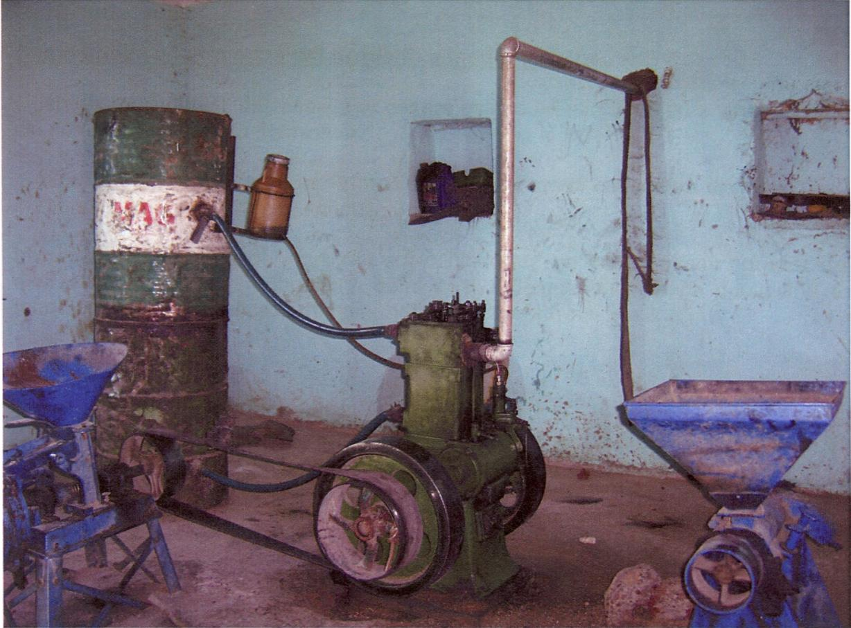
Il mulino multifunzionale è un insieme di 3 elementi chiamati mortai e azionati da un motore centrale.
